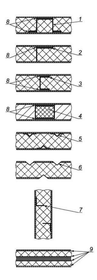
1 - скоба из стальной полосы; 2, 7 - угольники; 3 - швеллер; 4 - профиль прямоугольного сечения; 5 - гнутый профиль на контактной сварке; 6 - листы обшивки с гибом; 8 - теплоизоляционная прокладка; 9 - клеевой слой
