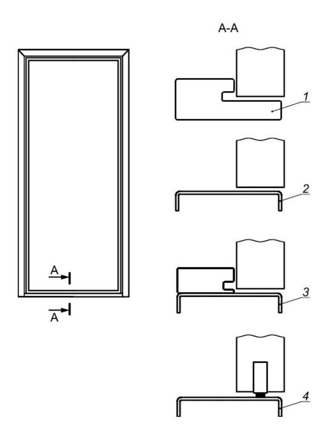
1 - с порогом с притвором; 2 - с порогом без притвора; 3 - с порогом без притвора и приставным; 4 - с порогом без притвора и выдвижным порогом
