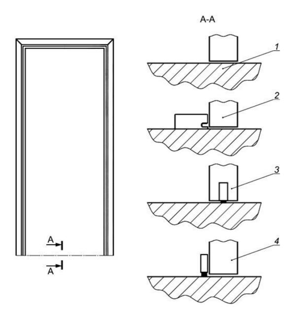
1 - без порога; 2 - с приставным порогом; 3 - с выдвижным порогом встроенного типа; 4 - с выдвижным порогом накладного типа
