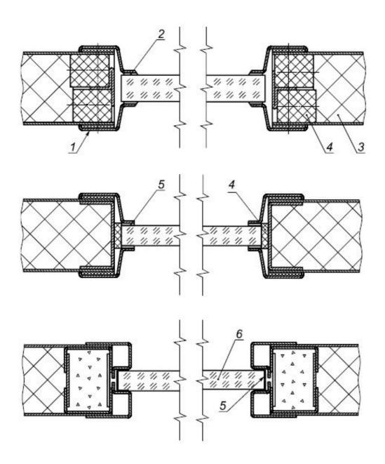
1 - стеклодержатель; 2 - уплотнитель; 3, 4 - негорючие теплоизоляционные материалы; 5 - терморасширяющиеся прокладки; 6 - остекление
